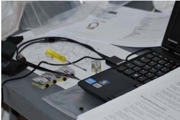
Abb. 3: Die GPS-Sender mussten alle sieben Tage zum Aufladen und für die Datennahme an einen Computer angeschlossen werden.
