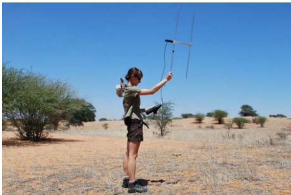
Abb. 5: Mit Hilfe der Radiotelemetrie konnten die mit dem VHF-Sender versehenen Tiere im Terrain wieder geortet werden.
