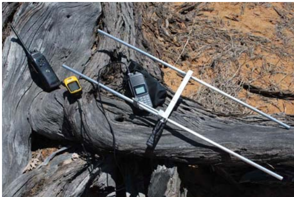
Abb. 4: Technische Ausstattung für die Feldarbeit, v.l.n.r.: Funkgerät, Hand-Navigationsgerät und Telemetrierequipment (Empfänger mit Antenne).
